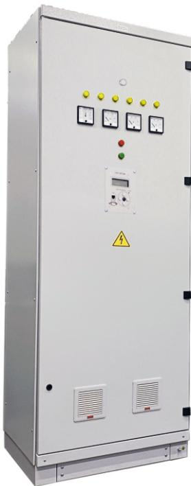
**Устройство стабилизации напряжения (УСН)** представляет собой низковольтное комплектное устройство шкафного исполнения с преобразователем постоянного напряжения, обеспечивающим стабилизацию выходного напряжения при снижении напряжения на входе и предназначено для использования в системах оперативного постоянного тока электрических станций и подстанций, имеющих в своем составе аккумуляторные батареи.
