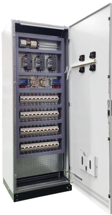
**Шкаф распределительный оперативного тока (ШРОТ)** представляет собой низковольтное комплектное устройство шкафного исполнения, предназначенное для питания оперативным током устройств релейной защиты и автоматики на электрических станциях и подстанциях.
